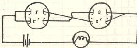
[Ex 12]：有一間車房置一電燈，車房兩房有兩間臥室，試設計如何在每間房子設置一個開關，可分別控制車房的電燈。
